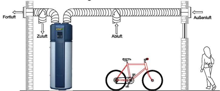
Ein optionales Kanalsystem mit integrierten Umschaltklappen
