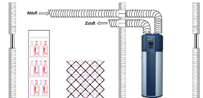
Raumluft wird z.B. aus dem Lagerraum abgesaugt, in der Wärmepumpe gekühlt sowie entfeuchtet und wieder eingeblasen
