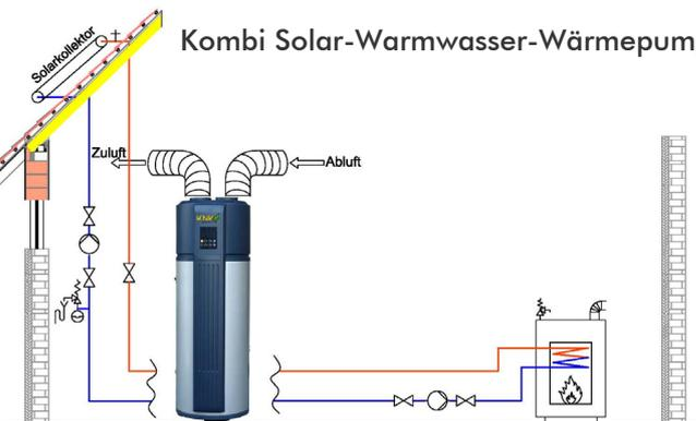
Der integrierte Wärmetauscher der Warmwasser-Wärmepumpe ermöglicht einen direkten Anschluss an eine Solaranlage oder an einen Heizkessel
